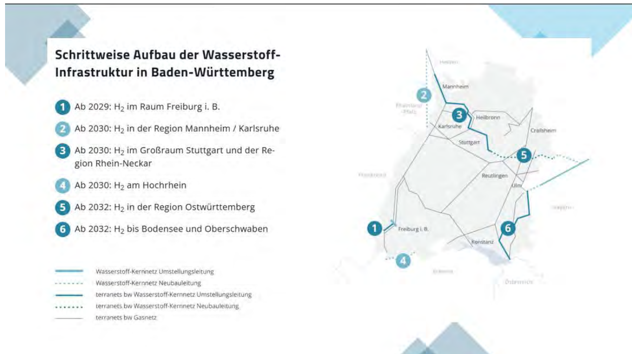
Abbildung 23 Aufbau Wasserstoff-Kernnetz Terranets BW (terranets bw, 2025)
